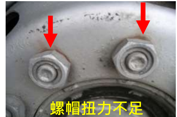
螺帽扭力不足 造成螺帽與鋼圈間 有鏽斑
